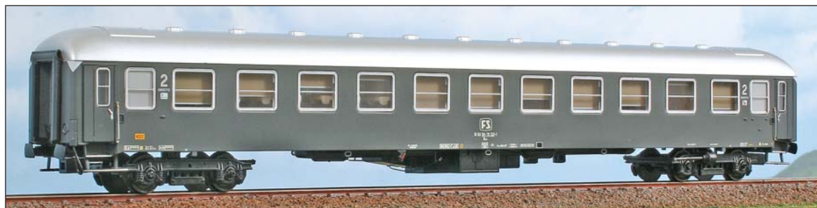
Carrozza FS Tipo UIC-X di 2ª classe a cuccette. Livrea grigio ardesia. FS Type UIC-X 2 nd class couchette car. Slate gray livery. Schlafwagen 2. Klasse Typ UIC-X der FS. Schiefergraue Lackierung.
